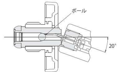
HS-5BPは落雪等で調整器に異常な負荷がかかると上図のように入口接続部が折れ、ボールが栓をしてLPガスの流出を防止する機構がっています。
