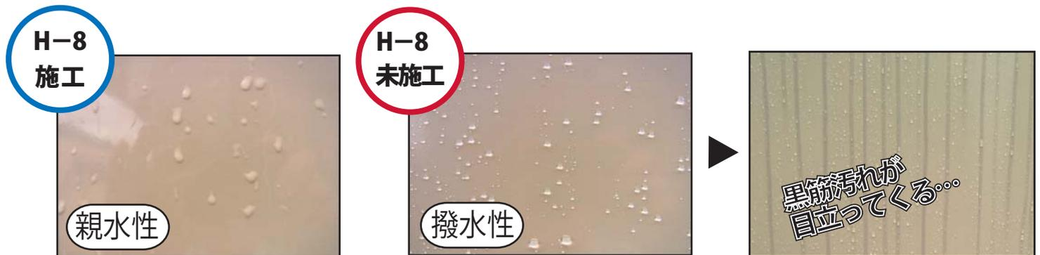
通常のバルク貯槽は撥水性があるため、水滴が付着してしまいます。これが黒筋汚れの原因となります。H-8 コーティングを施すことで、汚れを寄せ付けず、美しい外観を保ちます。
