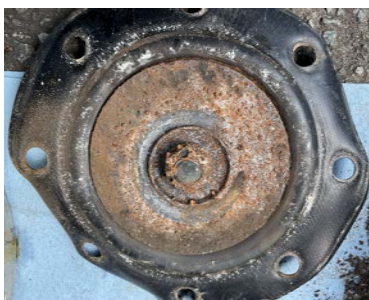
気化圧力調整弁の内部における受圧板の劣化およびドレンの滞留
