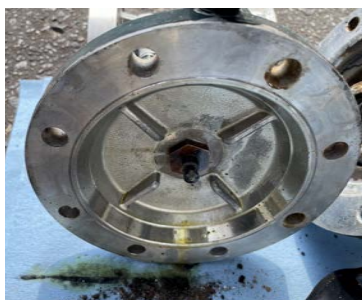
気化圧力調整弁の内部における受圧板の劣化およびドレンの滞留
